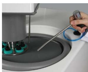
Herausziehbarer Wasserschlauch zur Reinigung
